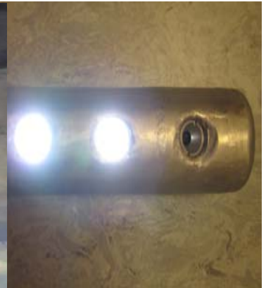
Zwei kräftige LED's sind in der wassergekühlten Kamera untergebracht.
